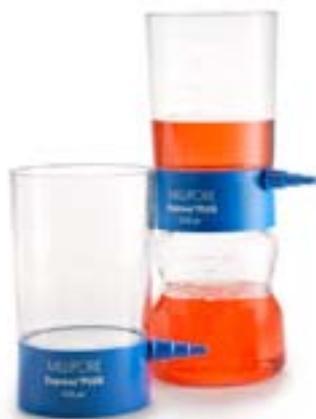
Stericup представляет собой готовую одноразовую систему для проведения стерильной вакуумной фильтрации. Система состоит из воронки с фильтродержателем и приемной колбы. На приемной колбе есть выемки для удобства удерживания сосуда в руках, также специальное строение приемной колбы позволяет сэкономить место при хранении фильтратов в ламинарном боксе.
