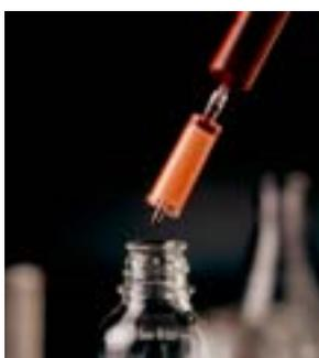
Фильтрационные насадки Sterivex можно использовать со шприцом или перистальтическим насосом. С помощью насадок Sterivex удобно фильтровать в любой тип емкости, а строение фильтра обеспечивает высокую пропускную способность (до 2000 мл).
