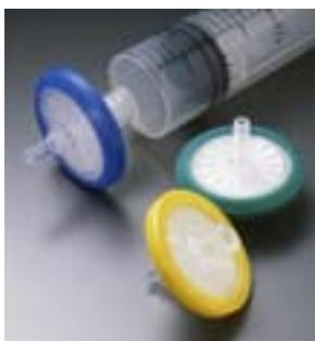
Для стерилизующей фильтрации проб небольшого объема оптимальным решением является использование одноразовых стерильных фильтрационных насадок на шприцы Millex. Данные насадки состоят из пластиковой рубашки, куда впаян мембранный фильтр из соответствующего задачам материала. Для удобства каждый тип мембраны имеет собственную цветовую кодировку:
